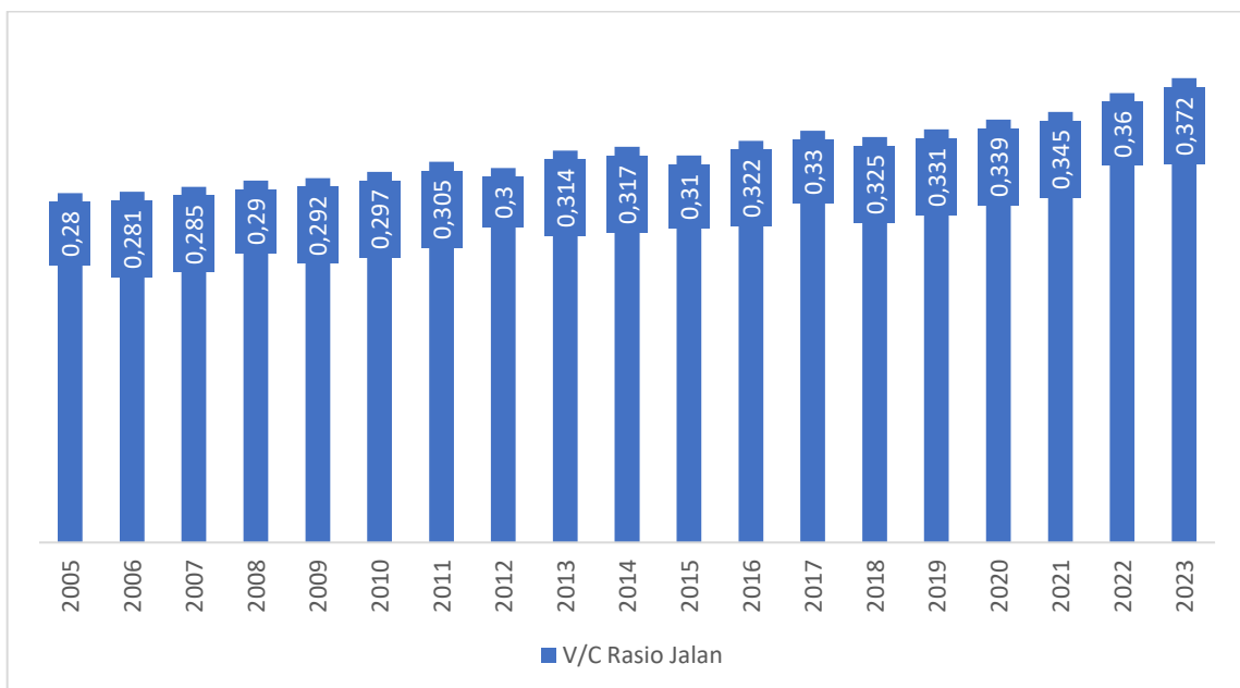
Gambar II. 71 Volume/Capacity (V/C) Rasio Jalan di Kabupaten Banyuwangi
